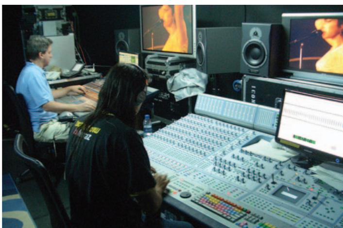
A unidade móvel da Gabisom, onde se efectuava o controlo das misturas broadcast, de forma independente do som de palco, e com gravação em ProTools com Icon D-Control
